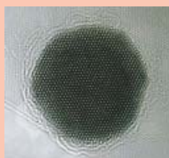
金ナノ粒子原子解像度イメージ 金ナノ粒子とその周囲のクエン酸塩キャッピング剤
